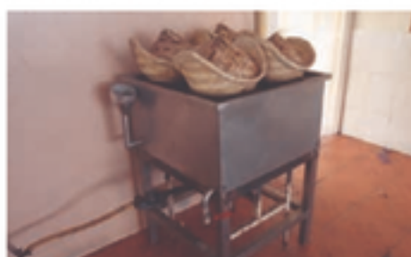
หม้อนึ่งข้าวที่ออกแบบปรับปรุงใหม่ พร้อมติดตั้งฉนวนลดการสูญเสียความร้อน
